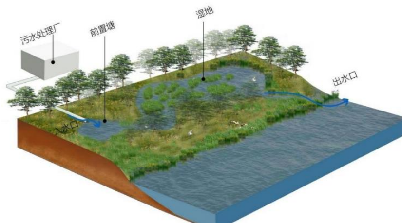
图 A.3 尾水湿地构建示意图
