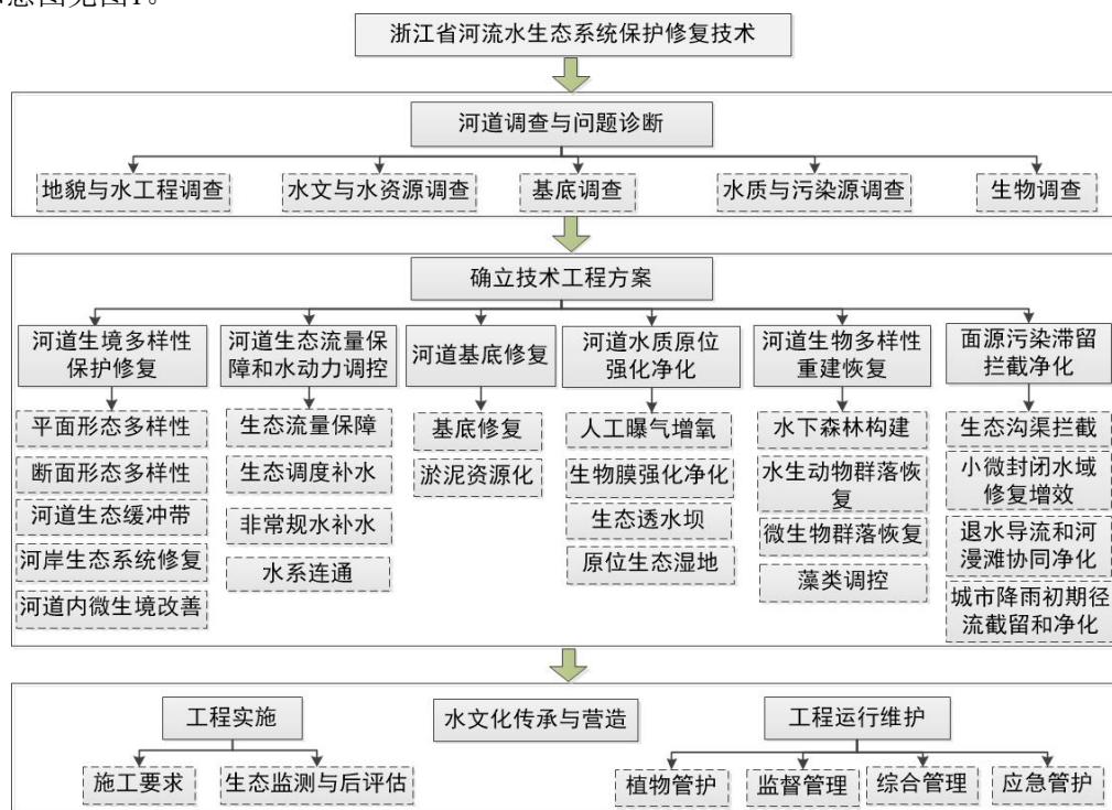
图 1 河流水生态保护修复技术流程图
