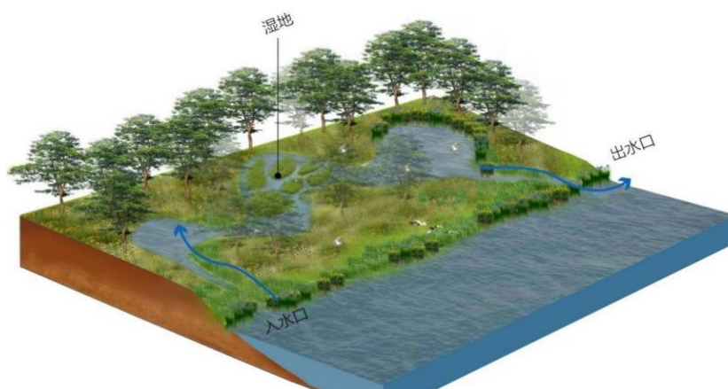
图 A.1 浅水旁路湿地构建示意图
